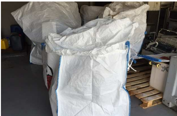
FOTO 85: Emmagatzematge correcte de fibra de vidre en big-bags homologats
