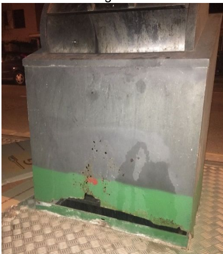
FOTOS 15 i 16: Desgasts produït per l'oxidació de les xapes metàl·liques dels contenidors de rebuig ubicats a l'avinguda Narcís Macià i Domènec i, posterior reparació.
