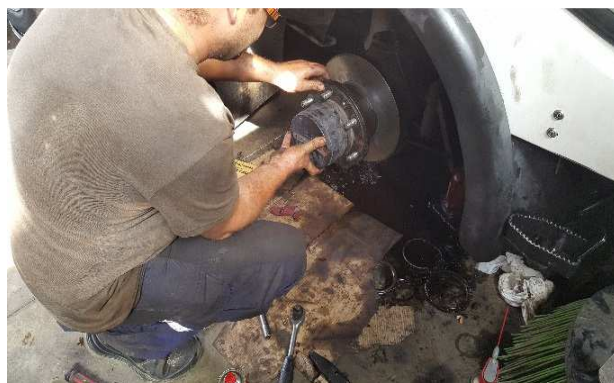
FOTOS 39 i 40: Canvi dels coixinets desgastats de les rodes de la direcció d'una màquina escombradora.
