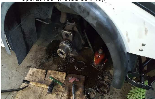
FOTOS 39 i 40: Canvi dels coixinets desgastats de les rodes de la direcció d'una màquina escombradora.
