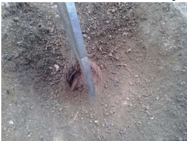
FOTOS 89 i 90: Cable d'acer deteriorat d'un ancoratge de l'estructura de la tirolina de Can Sabata i posterior canvi i millora amb una platina i cargol d'acer inoxidable.
