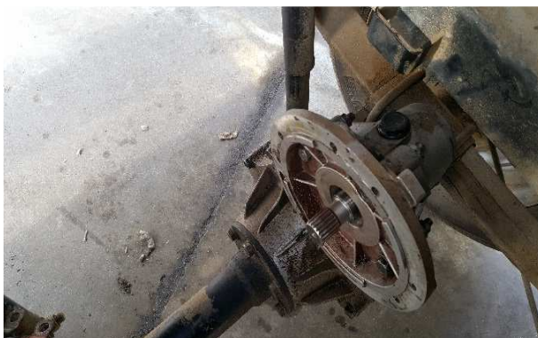
FOTOS 91 i 92: Avaria de la transmissió d'un vehicle elèctric del servei de neteja de les àrees d'esbarjo i posterior reparació.
