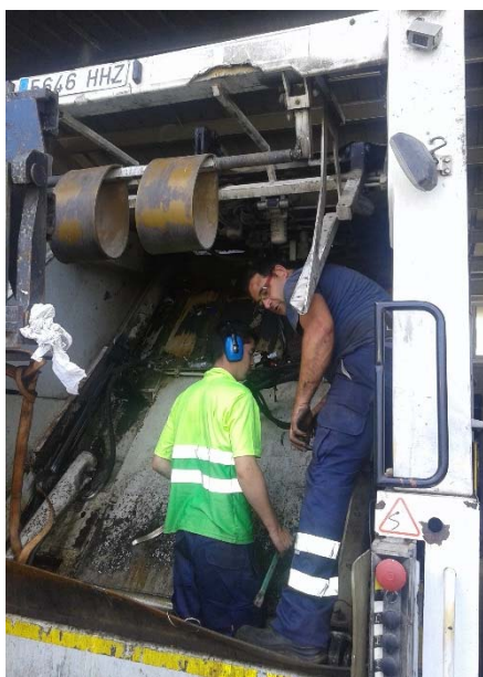
FOTOS 19 i 20: Reparació de la premsa d'un camió recol·lector i estat de la cambra d'escombraries d'un hotel.
