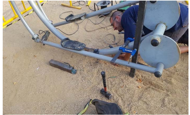
FOTOS 107 i 108: Trencament de l'estructura de la bici el·líptica de l'àrea de Salut de Can Sabata i posterior reparació amb soldadura i reforços.
