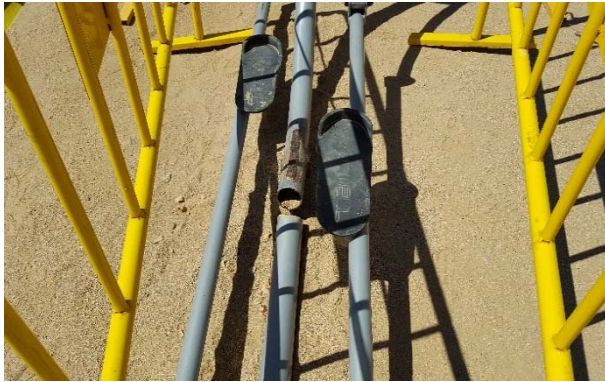
FOTOS 107 i 108: Trencament de l'estructura de la bici el·líptica de l'àrea de Salut de Can Sabata i posterior reparació amb soldadura i reforços.
