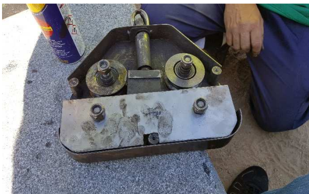
FOTOS 125 i 126: Reparació del mecanisme de la tirolina de Can Sabata i reparació de les escales d'accés a un joc per adequar-lo a la normativa de àrees infantils.
