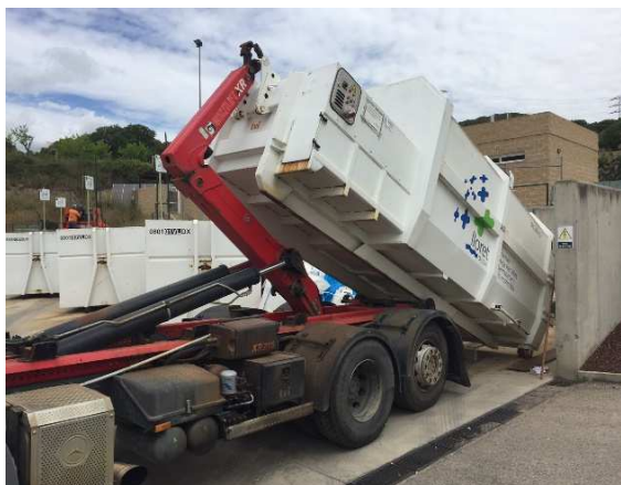
Foto 141: Descàrrega del contenidor-compactor de cartró.
