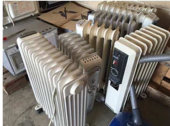
Foto 118: Emmagatzematge segregat de radiadors elèctrics com a categoria actual de recollida A2 (nova categoria FR4).
